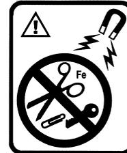
Symbol auf der Schubladenabdeckung des MRI-Fahrgestells. Keine mit der MRI-Umgebung inkompatiblen Gegenstände in das MRI-Fahrgestell legen.
