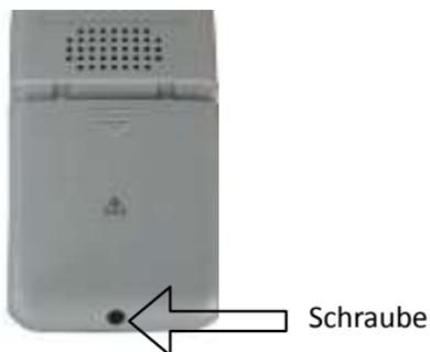
**Bild 8-1 Lösen der Schraube**
