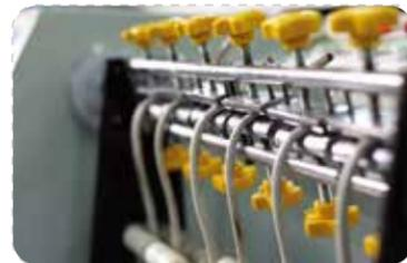
Biegesteifes Kabel, das mehr als 400.000 Tests standhält
