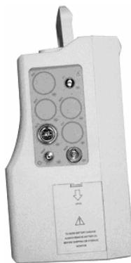
Abbildung 2-7 Batteriefachabdeckung
